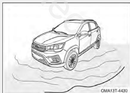
۱. هنگامی رانندگی در آب، مطمئن شوید که موتور به خوبی کار می‌کند و فرمان و ترمز نیز در حالت طبیعی خود هستند. در زمان رانندگی در آب باید از دنده سنگین استفاده کرده و از شتاب ناگهانی و گاز دادن یکباره پرهیز کنید. ممکن است شتاب ناگهانی باعث پاشیده شدن آب به موتور شود و در نتیجه موتور خاموش شود.
