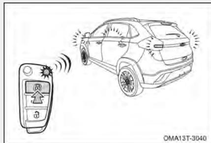
اگر یکی از دربها باز و یا نیمه باز مانده باشد، پس از زدن دکمه قفل روی کلید هوشمند یا ریموت کنترل کلیه دربها قفل شده و بلاfacسله باز خواهند شد، همزمان چراغ‌های راهنمایی دو بار چشمک زده و بوق به صدا در نخواهد آمد تا به رانتنده اعلام کند که سیستم دزدگیر فعال نشده است.
