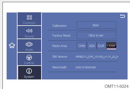
• Calibration: با فشار دادن دکمه start ، صفحه کالیبره کردن صفحه نمایش ، ظاهر می شود. با استفاده از یک قلم مناسب، مکان نمای واقع در وسط صفحه نمایش را به آرامی فشار دهید. مکان نما حرکت کرده و در محل جدید متوقف می شود. مجدداً مطابق حالت قبل با قلم بر روی مکان نما فشار دهید و این عمل را تا اتمام کالیبره شدن صفحه نمایش ادامه دهید.
